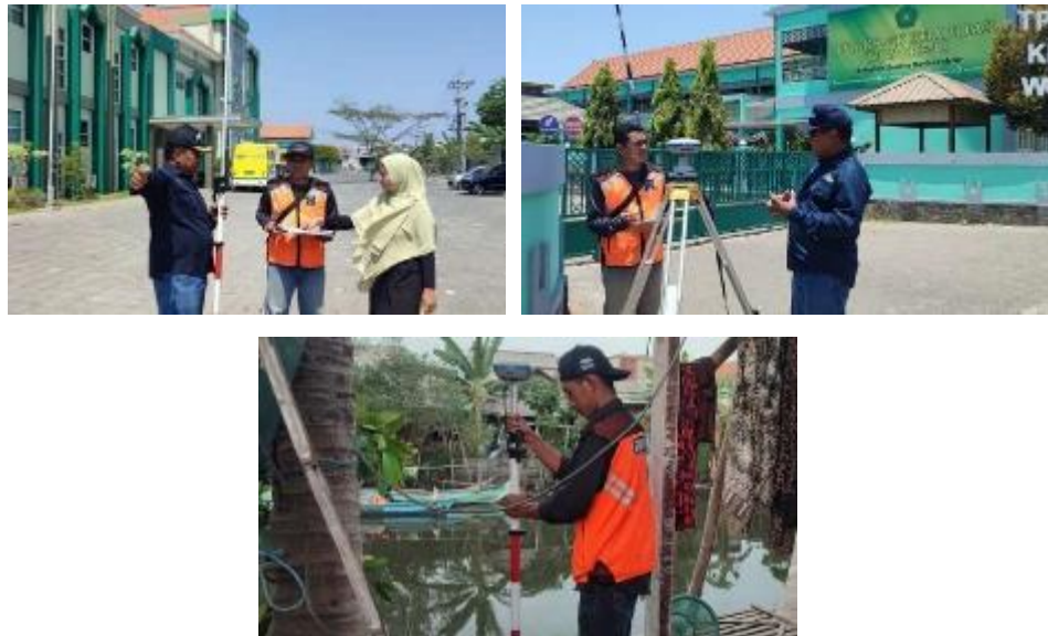
Gambar 4. Proses Pengukuran Detil Situasi dengan Metode GNSS-RTK
